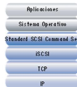
Figura 3.2. Pila del protocolo iSCSI
