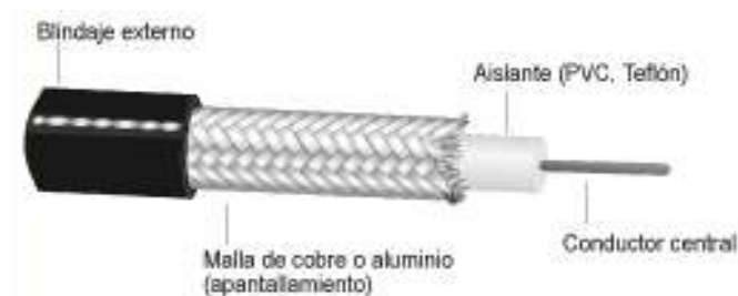
Figura No. 13 - Cable coaxial grueso.
