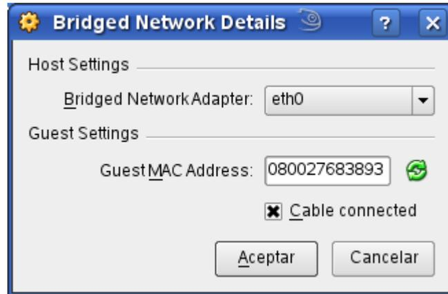
Con la opción Cable Connected, usted puede establecer comunicación entre la máquina virtual y el sistema operativo invitado.
